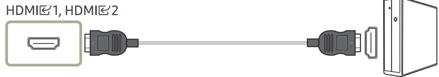
— Компоненттер ретінде жинақпен берілген HDMI кабелін пайдаланған жөн. Егер жинақпен берілмесе, HDMI кабель қосылымдары үшін міндетті түрде рұқсат етілген кабельді пайдаланыңыз. Рұқсат етілмеген HDMI кабелін пайдалансаңыз, кескін сапасы нашарлауы мүмкін.
