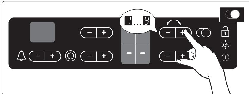
2. Для включения или выключения нагревательного элемента овальной формы нажмите пальцем сенсорную кнопку "Нагревательный элемент овальной формы" и удерживайте палец до тех пор, пока не включится или не выключится индикатор.
