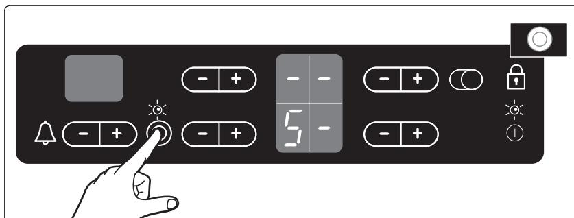
3. Для отключения большого нагревательного элемента снова нажмите сенсорную кнопку "Двойная конфорка ⓧ".
