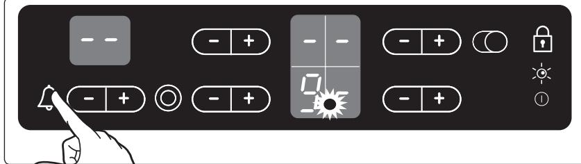
Для выбора следующей включенной конфорки снова нажмите сенсорную кнопку управления таймером  $\Delta$ .
