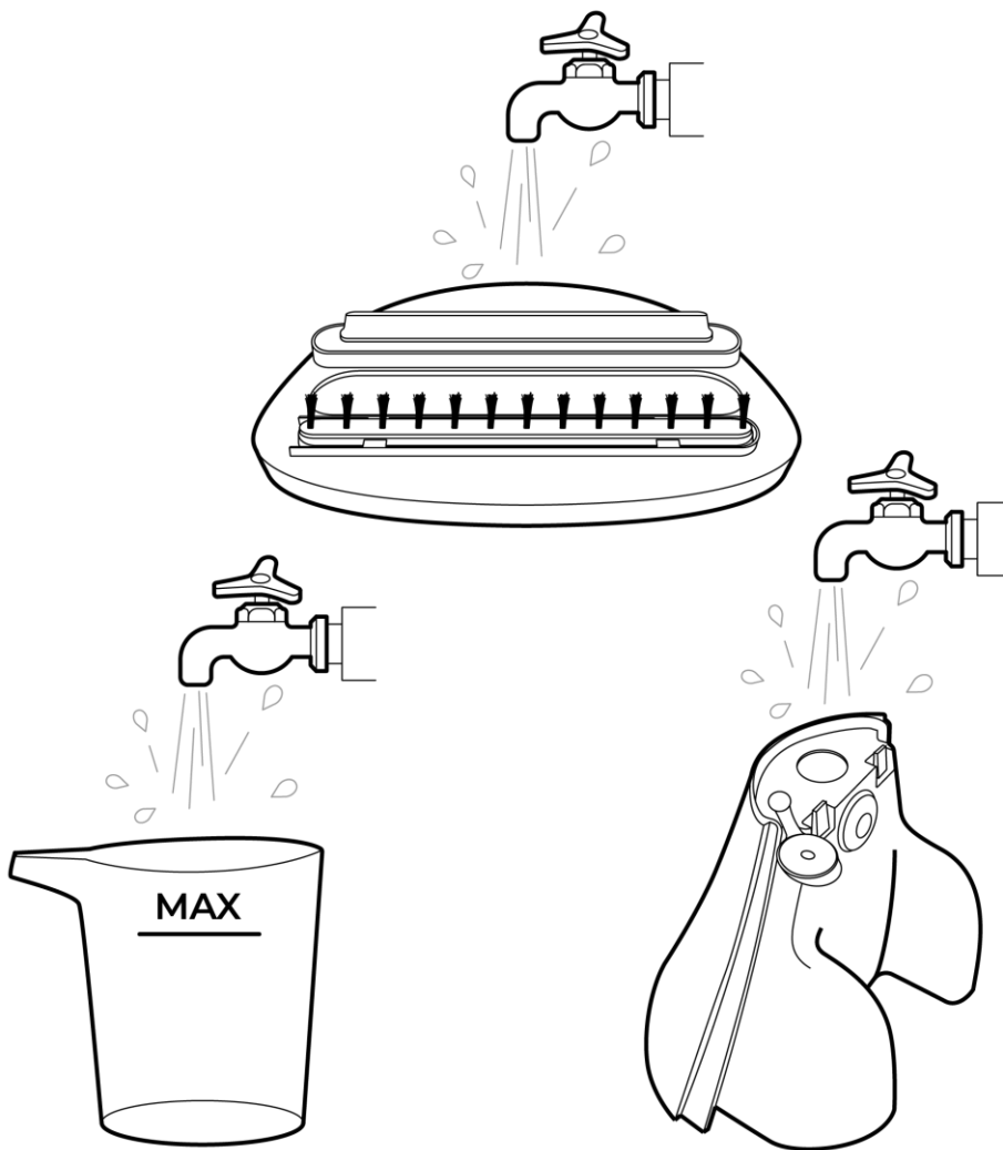
Рисунок 19 – Очистка резервуара для воды и аксессуаров
