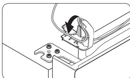
3. Уложите дверной провод в **крышку петли** перед установкой **крышки петли** на **верхнюю петлю**.
