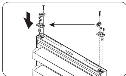
1. Снимите механизм автоматического закрывания и ограничитель с нижней части дверцы холодильной камеры. После этого установите их с противоположной стороны дверцы, как показано на картинке.
