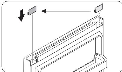
5. Снимите заглушку и установите ее с противоположной стороны.
