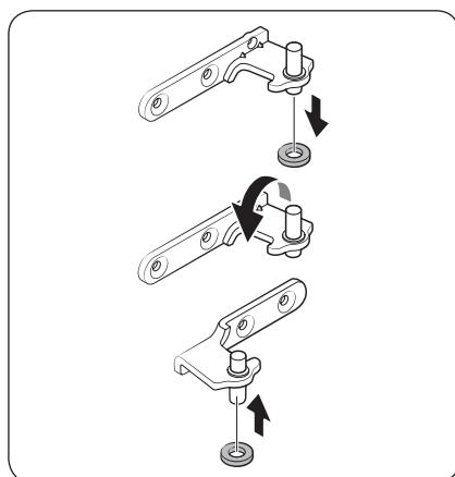
3. Снимите кольцевую прокладку со шпинделя средней петли, после чего установите прокладку с противоположной стороны шпинделя. Для справки см. рисунок.
