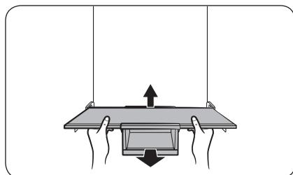
1. Приподнимите заднюю часть полки и аккуратно передвиньте ее вперед.
