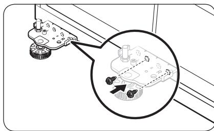
3. Расположите пластину нижней петли на противоположной стороне и прикрепите пластину петли двумя винтами, как показано на рисунке.
