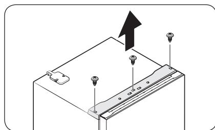
1. С помощью крестообразной отвертки выкрутите винты (3 шт.) из трех отверстий на **верхней пластины**. После этого осторожно вытяните верхнюю пластину.
