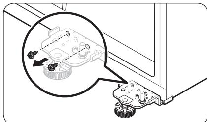
1. Отверткой выкрутите винт на нижней петле.
