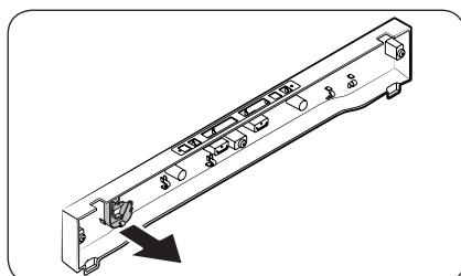
2. Вручную отсоедините **крышку петли** от верхней пластины.
