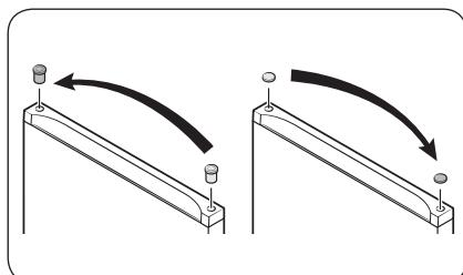
5. С помощью плоской отвертки снимите прокладку **петли** с одной стороны и **заглушку отверстия для петли** с другой стороны. Установите их соответственно с противоположных сторон.
