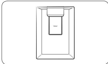
4. Диспенсердің су шүмегінің астына стакан қойып, стаканыңызбен су диспенсерінің тұтқасын абайлап итеріңіз.
