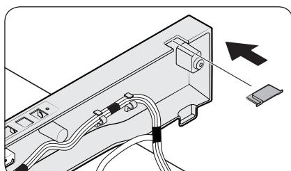
6. Установите верхнюю пластину и надежно закрепите ее на холодильнике с помощью винтов (3 шт.).
