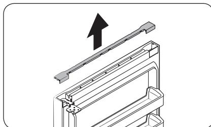
1. Чтобы снять **защитную крышку** сверху дверцы морозильной камеры, потяните ее вверх.
