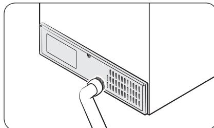
Чтобы поддерживать чистоту кабелей и внешних деталей задней панели, пылесосьте ее один или два раза в год.
