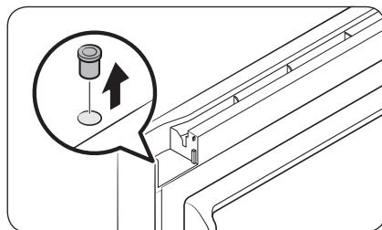
2. С помощью плоской отвертки снимите прокладку петли.
