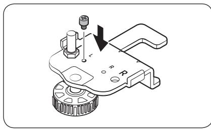
2. Вставьте болт петли в пластину нижней петли сверху, как показано на рисунке, и надежно затяните его.
