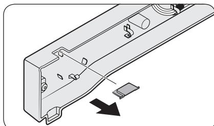
5. Снимите заглушку отверстия для петли с верхней пластины, после чего установите ее с противоположной стороны.
