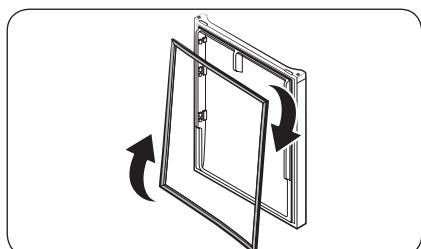
8. Снимите уплотнители дверей морозильной и холодильной камер. Переверните их по часовой стрелке на 180 градусов и установите обратно.
