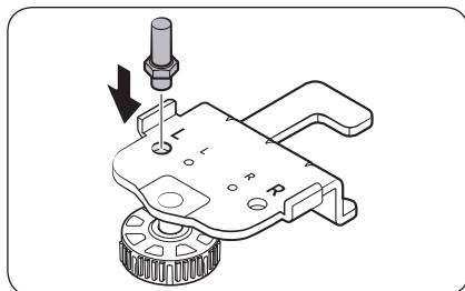
1. Вставьте шпиндель дверцы в пластину нижней петли сверху, как показано на рисунке, и надежно затяните его.
