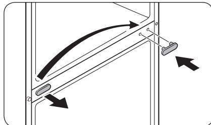
1. С помощью плоской отвертки снимите заглушку винта средней петли, после чего установите ее с противоположной стороны.
