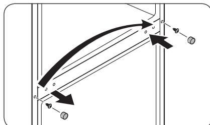
2. С помощью плоской отвертки снимите заглушку винта с буртиком, чтобы получить доступ к винту с буртиком. С помощью крестообразной отвертки снимите винт с буртиком, после чего установите и закрепите его с противоположной стороны. После этого установите заглушку винта с буртиком с противоположной стороны.
