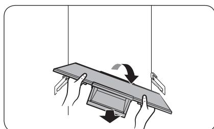
2. Наклоните полку в одну сторону и выньте ее.
