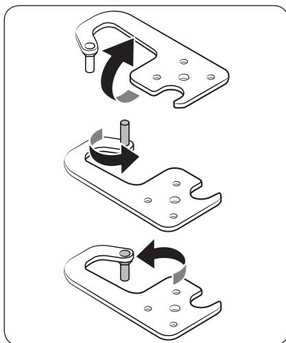
6. Снимите шпиндель дверцы с верхней петли, поверните его на 180 градусов, как показано на картинке, после чего установите его на место.
