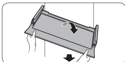
2. Наклоните полку в одну сторону и выньте ее.
