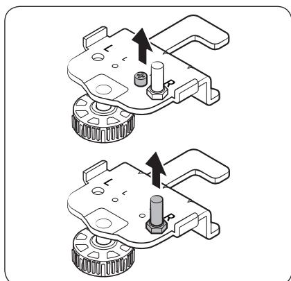
2. Отверткой выкрутите болт петли. Ключом снимите шпиндель дверцы.
