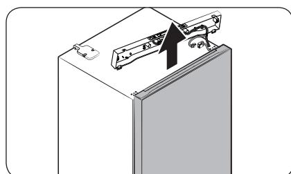
4. Осторожно приподнимите **дверцу морозильной камеры**, чтобы снять ее.
