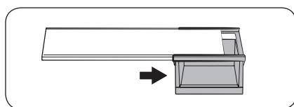
3. Толкайте съемный лоток сбоку, чтобы отделить его от полки.
