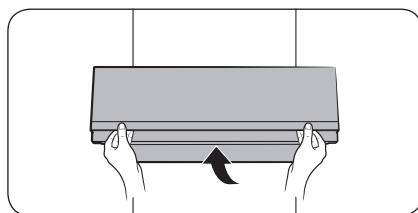
2. Слегка поднимите ящик для овощей, а затем вытяните его.
