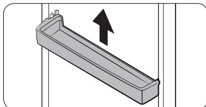
Слегка приподнимите и извлеките дверной лоток.
