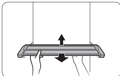
1. Приподнимите заднюю часть полки и аккуратно передвиньте ее вперед.
