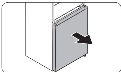
6. Осторожно вытяните **дверцу холодильной камеры** из **шпинделя петли**, после чего приподнимите, чтобы снять ее.
