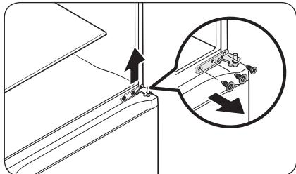
5. С помощью отвертки и гаечного ключа выкрутите болты и снимите **среднюю петлю**.
